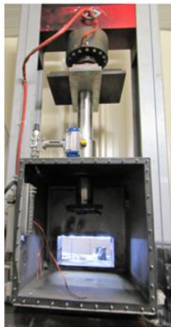
ONU T.6 Epreuve d'impact écrasement par presse
