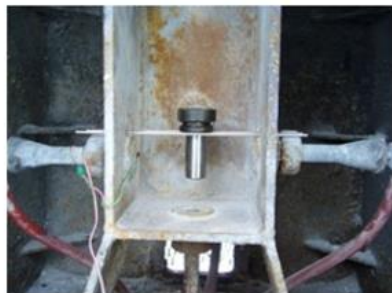
Douille de Koenen Epreuve de sensibilité au chauffage sous confinement
