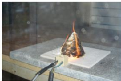
ONU O.1/O.3 – Epreuve d'accroissement de la vitesse de combustion des solides comburants
